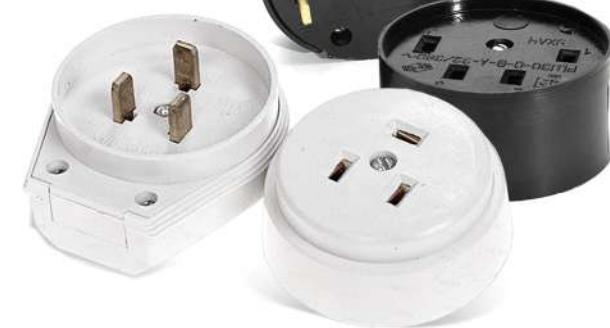
Штепельные соединители: розетки и вилки предназначены для подсоединения электротехнических устройств к трехфазной или однофазной сети переменного тока напряжением соответственно 250/380 В с потребляемой мощностью до 7 кВт и током до 32 А.
