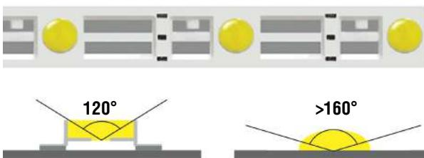
Рис.1 Угол распределения светового потока.
