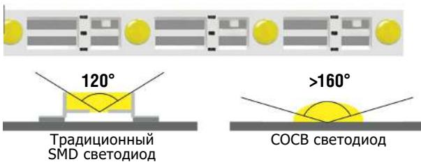
Рис.1 Угол распределения светового потока.
