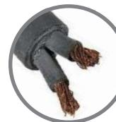
**КГ** – Кабель силовой гибкий с медными многопроволочными жилами с резиновой изоляцией и в резиновой оболочке. Расчитан на напряжение до 660 В.
