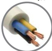
**ПВХ** – провод со скрученными медными жилами с ПВХ изоляцией, ПВХ оболочкой, гибкий. Расчитан на напряжение до 380 В.
