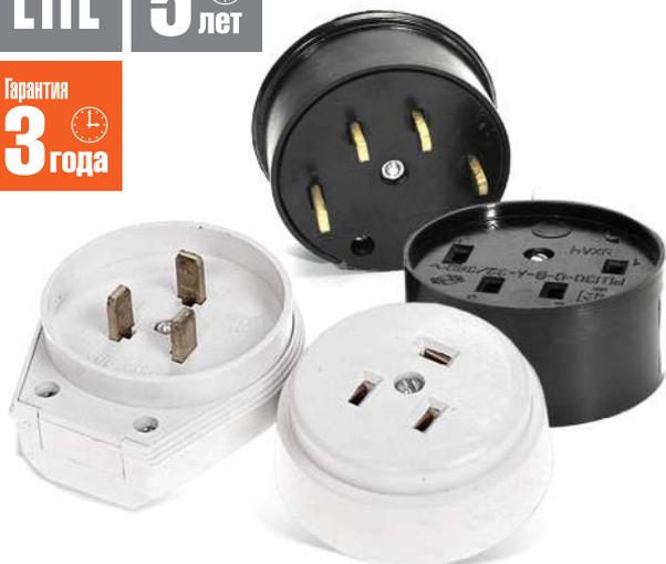
Штепсельные соединители: розетки и вилки предназначены для подсоединения электротехнических устройств к трехфазной или однофазной сети переменного тока напряжением соответственно 250/380 В с потребляемой мощностью до 7 кВт и током до 32 А.
