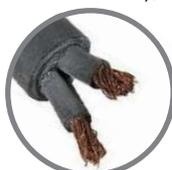
**КГ** – Кабель силовой гибкий с медными многопроволочными жилами с резиновой изоляцией и в резиновой оболочке. Расчитан на напряжение до 660 В.
